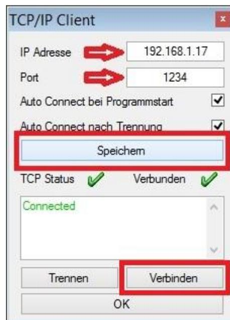
Im Fenster "TCP/IP Client" im Feld "IP Adresse" geben Sie die IP Adresse des Caliper2PC Interfaces ein (z.B. 192.168.1.17 siehe Seite 17). Im Feld "Port" geben Sie die Port Nummer ein, die im Interface definiert wurde (z.B. 1234 siehe Seite 18). Klicken Sie anschließend auf die Schaltfläche "Speichern", um die Werte zu übernehmen. Mit einem Klick auf die Schaltfläche "Verbinden" wird der TCP/IP Client mit dem Interface verbunden.
