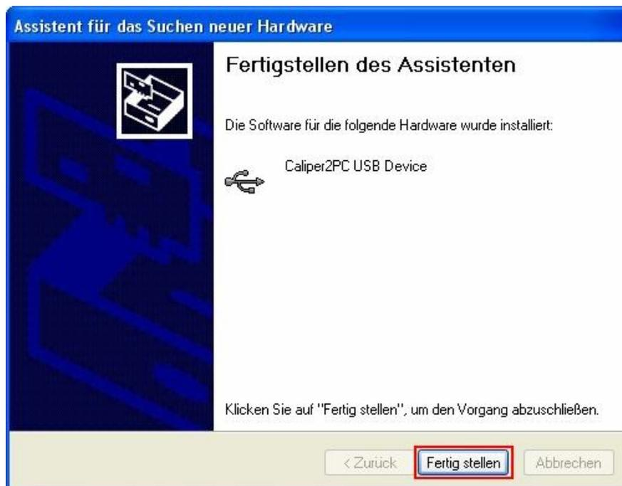
Nach dem Klicken der Schaltfläche "Fertig stellen", ist die Installation des USB - Treibers abgeschlossen.
