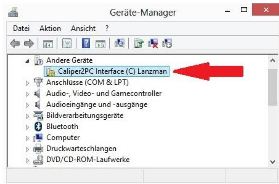
Das Caliper2PC Interface sollte im Geräte-Manager unter „Andere Geräte“ sichtbar sein.
