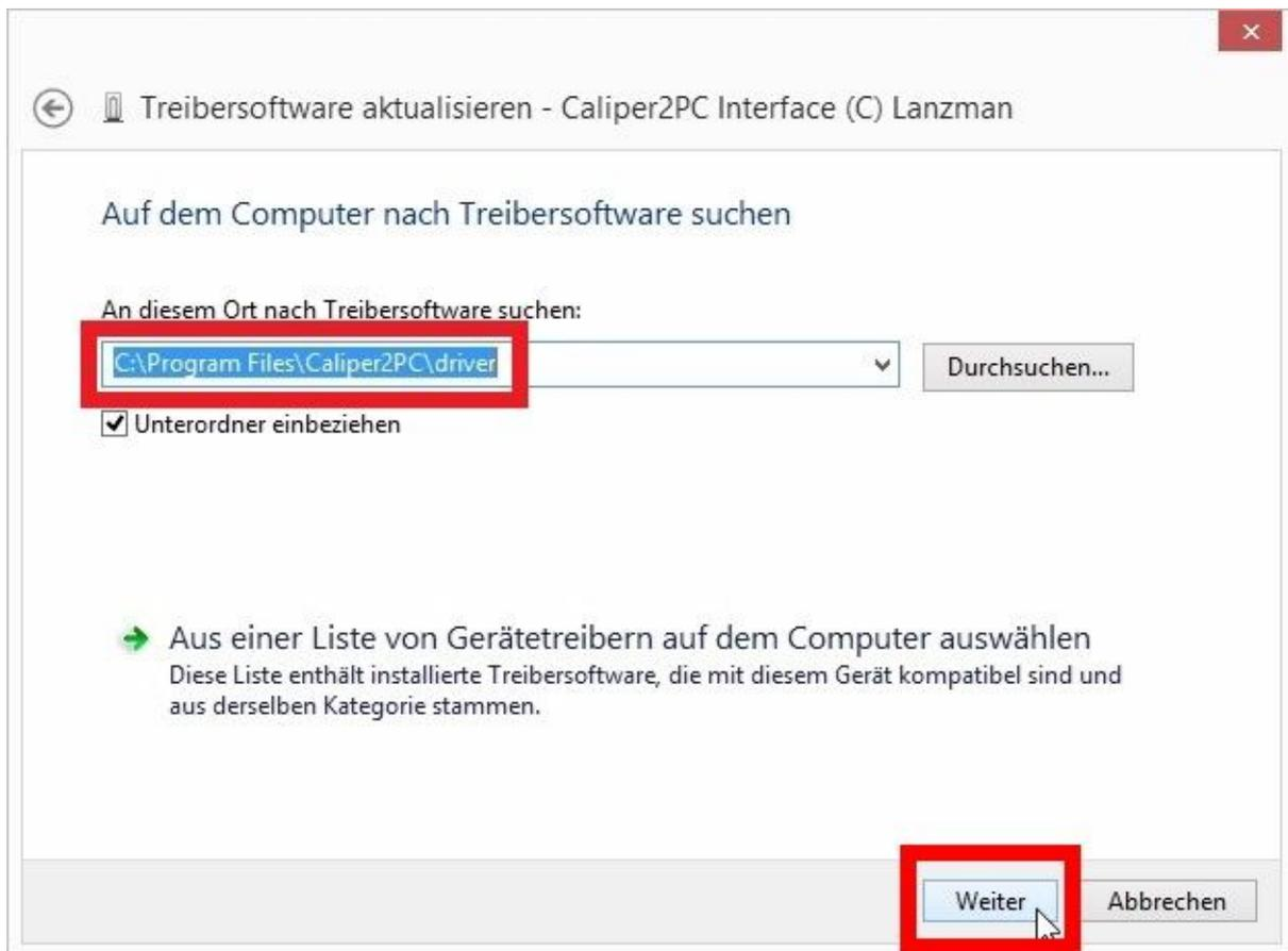
Der Treiber befindet sich im Unterordner "driver" des Caliper2PC Ordners. Wenn der vorgegebene Installationspfad während der Softwareinstallation nicht geändert wurde und das Betriebssystem auf Festplatte C:\ installiert ist, wird folgende Quelle für den Treiber angegeben: **"C:\Program Files\Caliper2PC\driver"**. Überprüfen Sie den Pfad und klicken Sie anschliessend auf "Weiter".
